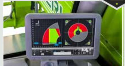
Das ASCS ermöglicht es dem Bediener, die Geschwindigkeiten der Hydraulikbewegungen einzustellen und die geometrischen Grenzwerte zu verwalten, innerhalb derer der Arm sicher eingesetzt werden kann. Darüber hinaus sind bis zu 6 unterschiedliche Benutzerprofile möglich.
