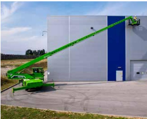
Arm bestehend aus einem doppelten „C“-Querschnitt aus hochfestem Stahl mit Schweißnähten entlang der neutralen Biegeachse. Hydraulikleitungen und Stromkabel, die im Arm angeordnet sind, garantieren Schutz vor möglichen Stößen und erleichtern die Wartung. Die „L“-förmigen Gleitschuhe aus Verbundwerkstoff gewährleisten maximale Leistungsfähigkeit, da sie die Belastung und den Verschleiß auf den Gleitflächen reduzieren. Der Merlo Teleskoparm bietet:
