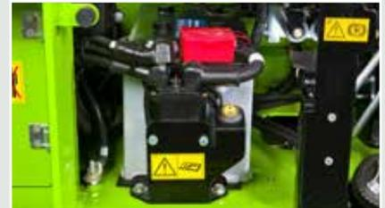
Um den Wirkungsgrad und die Lebensdauer der Batterien zu erhöhen, sind die Rotoren serienmäßig mit einem elektrischen sowie automatischen Batterietrennschalter ausgestattet. Ist der Stromkreis getrennt, reicht es aus, einfach den Schlüssel in die Zündung einzustecken, um die Batterien so wieder zu aktivieren.
