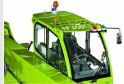
Eine Metallstruktur auf dem Glasdach ermöglicht es, eine der strengsten Schutz Zertifizierungen zu erhalten: die FOPS Stufe II.
